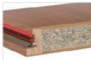
Vyplnění speciální deskou HALSPAN: 44 mm [EI30] / 54 mm [EI60]
