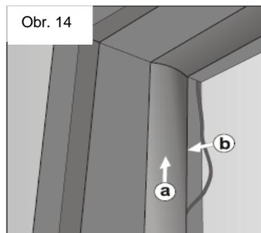
7. Umístěte zárubeň do otvoru dveří a následně ji zajistěte před náhodným vypadnutím pomocí montážního úchytu (obr. 6). Horní rohy zárubně zajistit dřevěnými klíny. Potom upravit rovinu horní příčky a svislý směr bočních příček. Upravujte jejich polohu pomocí dřevěných klínů, umístěných ve výši plánovaných nastavitelných rozpěr (obr. 6). Instalujte nastavitelné rozpěry (doporučované jsou čtyři). Nasadte křídlo dveří. Jestliže křídlo nepřiléhá přesně k zárubni, je možná korekce nastavení zárubně.
