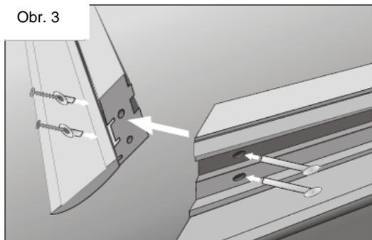
5. Spojte hlavní příčky zároveň (boční a horní) pomocí šroubů a plastových spojek (obr. 3).
