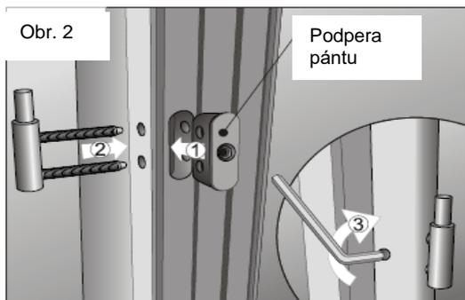
2. Před začátkem montáže je třeba vzít do úvahy tloušťku zdi, jelikož standardní rozsah nastavení zároveň je 80 až 180 mm. Jestliže je tloušťka mimo standardního rozsahu nastavení, je třeba zakoupit regulační vložku, jež zvětší rozsah nastavení zároveň od 180 do 280 mm.
